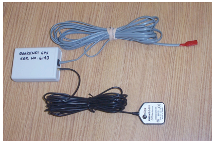
5a. temp sensor, GPS antenna → GPS module; 5b. GPS module → DAQ: Cat5 green cable
